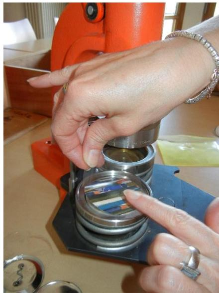
**3. Schritt:** Schwenkplatte drehen. Der Unterstempel steht jetzt direkt unter dem Oberstempel. Betätigungshebel bis zum Druckpunkt nach vorne ziehen. Das Oberteil mit Papier und Folie befindet sich jetzt in dem Oberstempel.
